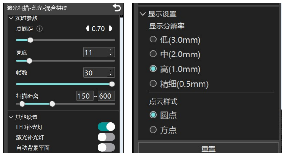
图 7-7 激光混合拼接扫描参数设置界面
