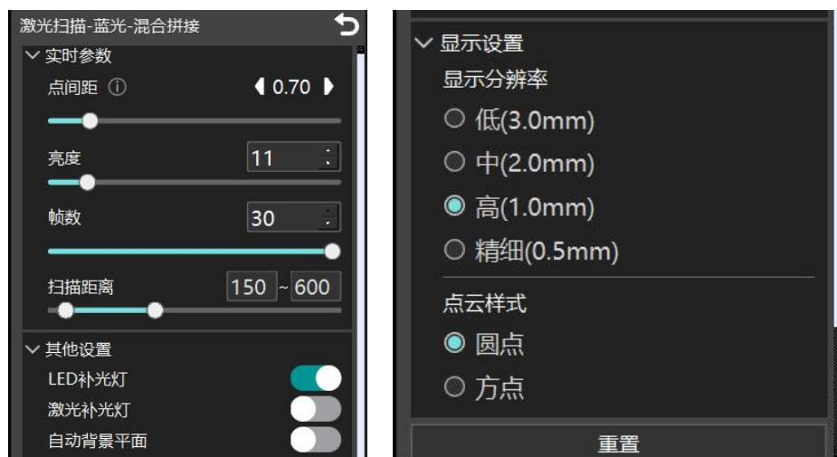
图 7-8 激光混合拼接扫描参数设置界面
