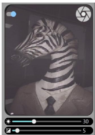
图 7-14 实时相机画面及彩色相机补光灯、彩色相机亮度调整方法
